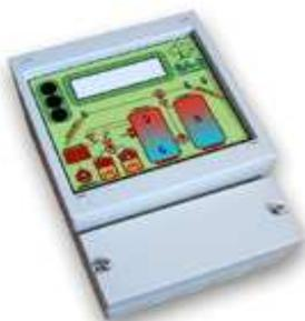
Diferencijalna automatika SA-3 namjenjena je za upravljanje solarnim zagrijavanjem sanitarne tople vode, solarnog grijanja, kotlom na kruto/tekuće/plinovito gorivo i dogrijavanjem putem elektro grijača. Diferencijalna automatika SA-3 ima mogućnost upravljanja sa dva solarna polja (istok/zapad), dva kotla i dva spremnika tople vode.
